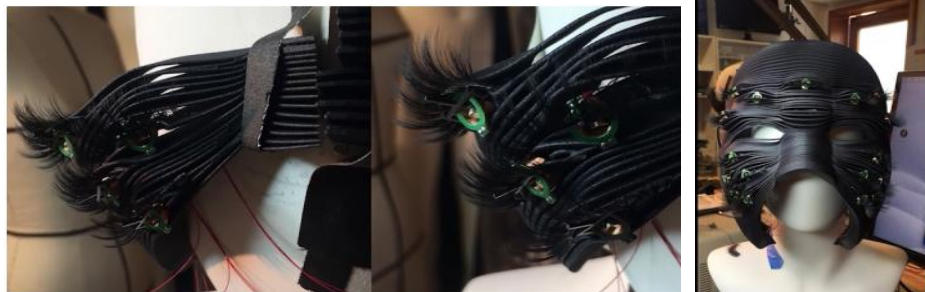
تصویر 4. قرارگیری محرک‌های الکترومغناطیسی روی نقاب منبع: Farahi, 2020: 726
