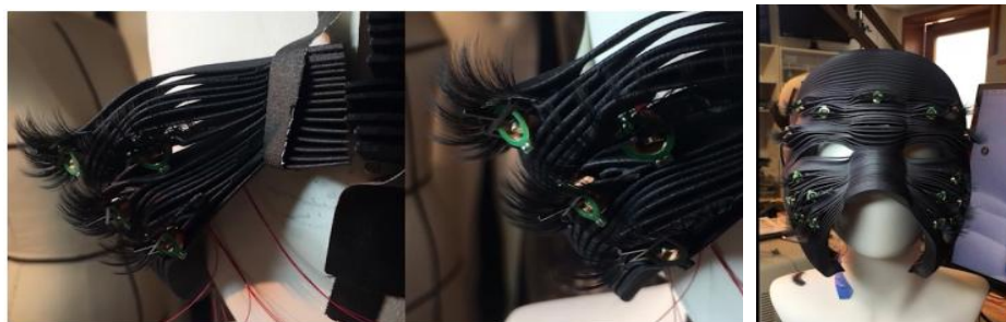
تصویر ۴. قرارگیری محرک‌های الکترومغناطیسی روی نقاب منبع: Farahi, 2020: 726
